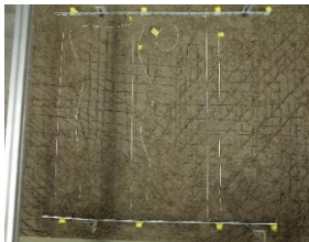
図-2 光ファイバ埋設状況
