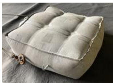
図-1 布製型枠試験体
