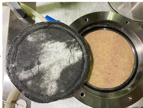
図-7 ノロ付着透気防水シートサンプル
