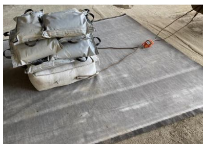
図-3 布製型枠／粗面加工シートの摩擦係数試験状況
