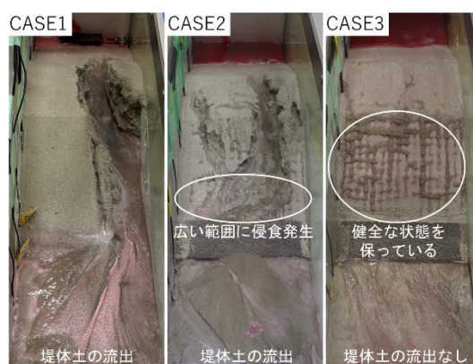
図-4 堤体下流側の侵食状況
