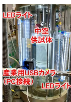
図2 せん断中の供試体の撮影
