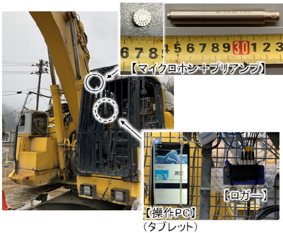
図-2 マイクロホン・操作 PC・ロガーの設置状況
