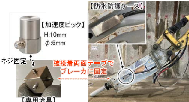
図-1 加速度ピックの設置状況
