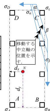
図-4 荷重条件における中立軸の移動状況
