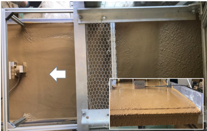
写真-4 含水比の違いが土砂移動に与える影響 (w/c ≒ 30%)
