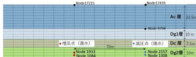
図2 解析モデル(y=50m断面図, Case2b)
