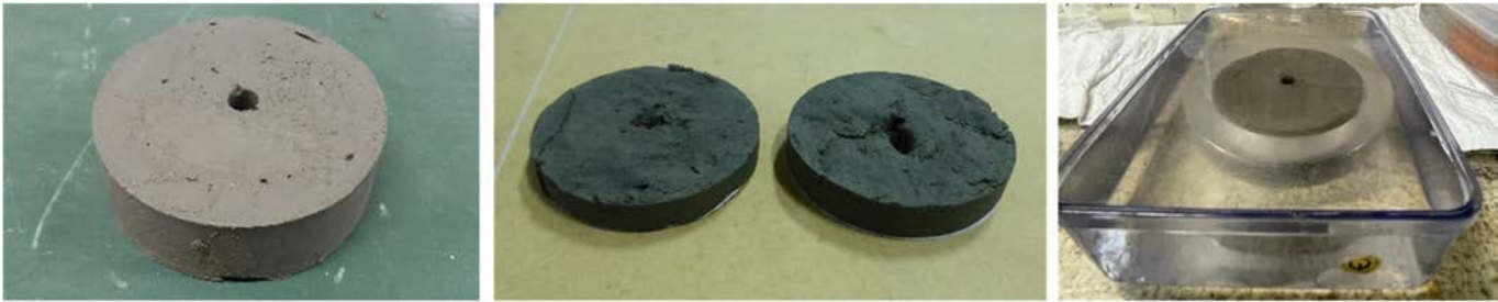
図-2 供試体の様子 (左から, せん断前, せん断後, 固化溶液浸漬時)
