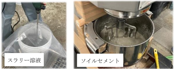
図 2 試料の練混ぜ状況
