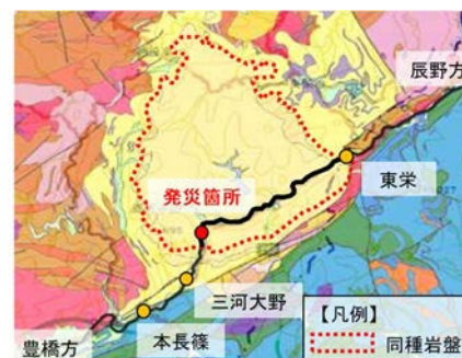
図-4 岩石落下箇所付近の地質 2)
