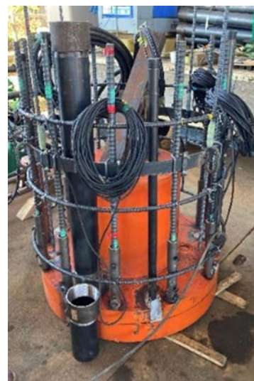
図-2 試験杭先端部詳細
