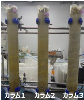
写真1 地下水通水後
