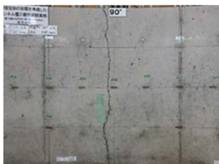
(a) 供試体内面 (b) 供試体上面 写真2 ひび割れ発生状況（実験終了時撮影）
