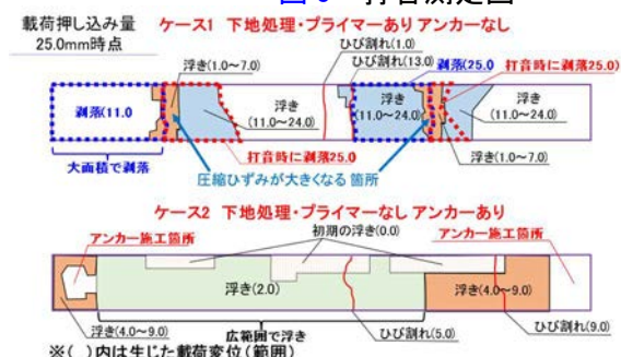
図 4 浮き範囲（括弧内数字は当該変状が初めに確認された時点の載荷変位）
