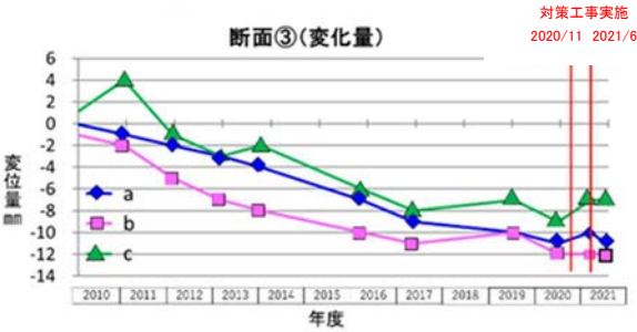
図-8 内空断面測定結果(最大変状箇所)
