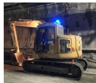
写真-4 回転灯設置した重機
