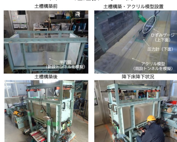
図2 降下床実験の状況
