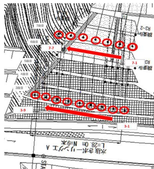
図-3 水抜きボーリング工
