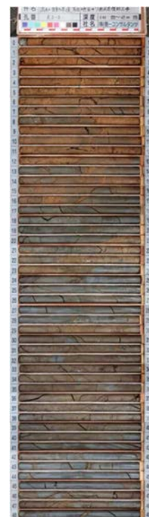
図-6 R3-2 ボーリングコア
