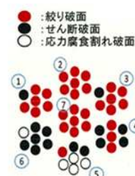
図-4 I-3 F70TA 破断面状況 図-5 D-13 F70TA 破断面状況
