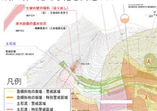
図-4 土砂災害警戒区域・土砂災害特別警戒区域と法面防災カルテの重ね合わせ
