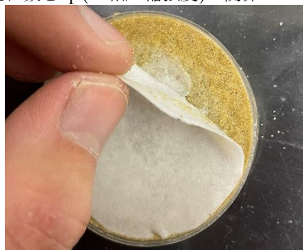
写真-1 ろ紙が剥がれなかった供試体
