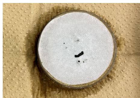
写真-2 黒い錆が生じた供試体
