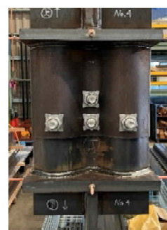
写真-4 8.8 引張試験体
