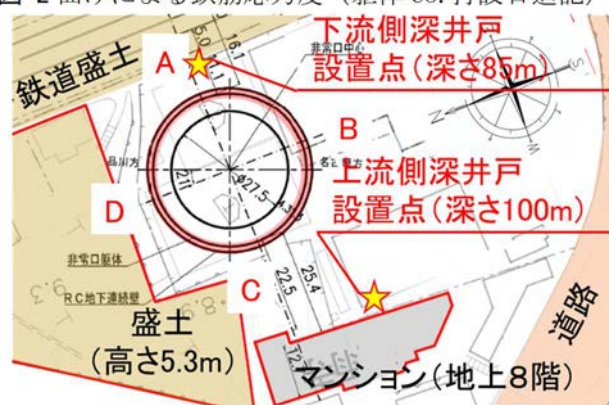
図-3 地下水位観測位置
