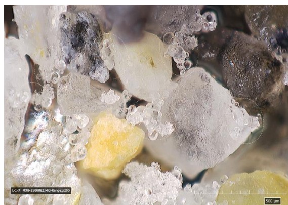
図 3 固化処理後に砂粒子間に析出した炭酸カルシウムの結晶（×200 倍）
