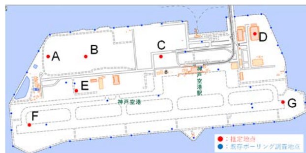
図-2 ボーリング調査地点と推定地点
