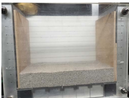
図6 側壁作用荷重の測定装置
