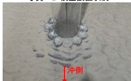
写真－5 造波後の状況
