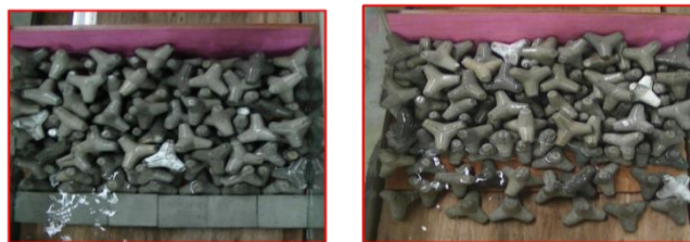
写真-2 消波ブロックの捕捉効果
