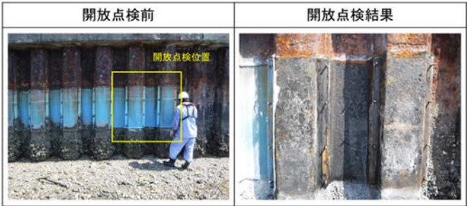
図 4 実環境下暴露試験の開放点検結果
