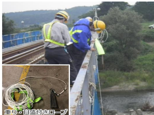
図-1 計測状況 (レッド測深)
