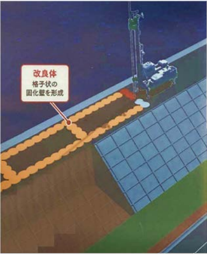
図 1. 改良体施工イメージ
