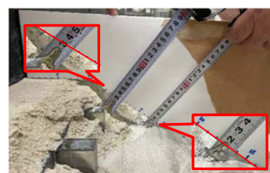
図 11. 1.25m 地点での断面洗掘状況
