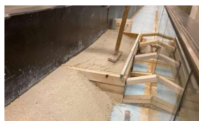
図 5. 堤体作成状況
