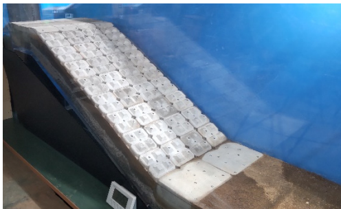
図-2 被覆ブロック設置状況
