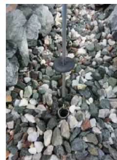
(a) コーティングしたコイル (b) 使用したゴム栓 写真 2 コイルとその上部に装着するゴム栓
