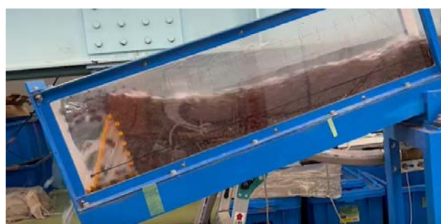
写真-3 軽量骨材の土石流が跳ね上がる様子
