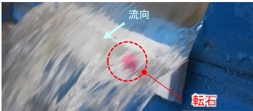
図 4 チロル上部の転石の流下状況 (100 年確率)
