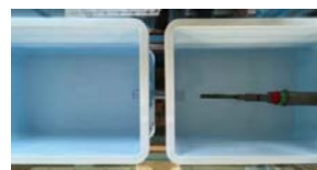
写真2 容積法②（吸引側と吐出側を仕切って測定）
