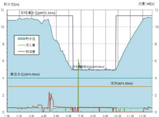
図-1 権現堂調節池の貯水位・流入量・放流量の年間変動（2020 年の事例）
