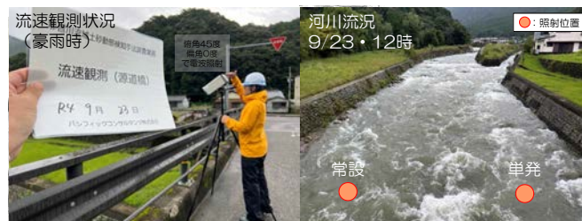
図-4 電波流速計による流速観測（那智川本川：源道橋）
