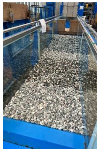
写真1 堰堤模型下流側の設置状態
