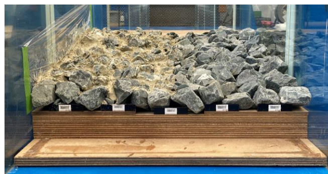
写真1 中央より右岸側の礫の隙間を埋めた状態
