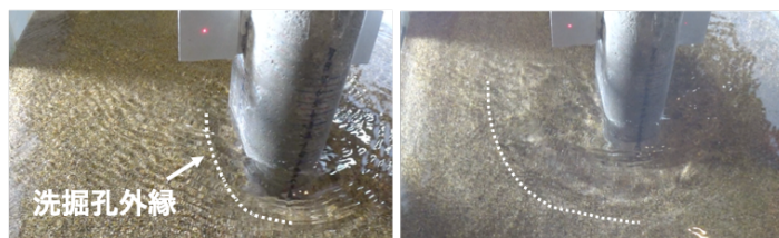
図5 Case50における洗掘孔外縁の時間変化 (左:1500秒, 右:29580秒)
