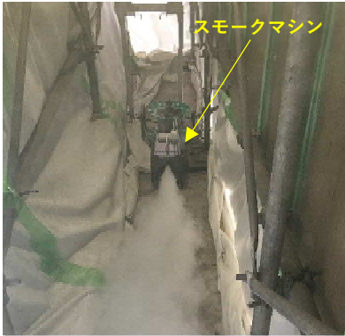
写真-2. ドライスモーク噴射状況
