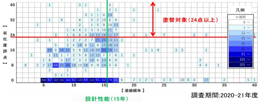
図－2 塗装経年と劣化度評点の関係
