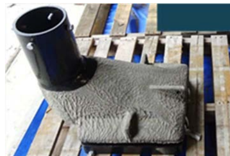
図-4 付着強化処理後の排水桝
