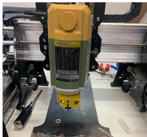
写真-2 切削部（フライスモーター）
