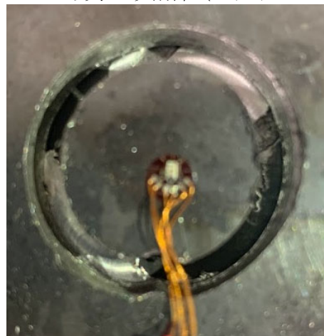
写真-3 実際の切削状況（中央にひずみゲージ）
