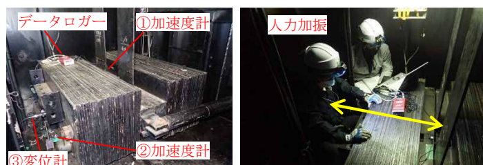
写真 2 減衰性能試験状況
