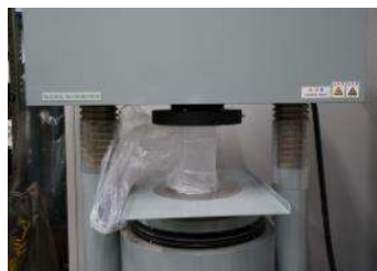
写真-1 圧縮試験
