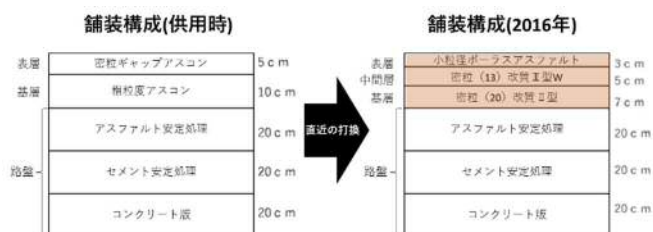
図-3 舗装補修範囲の直近の舗装構成履歴図
