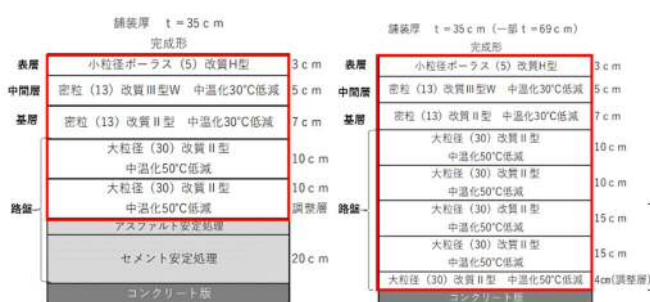
図-4 打換え後の舗装構成(左: 35 cm, 右: 69cm)
