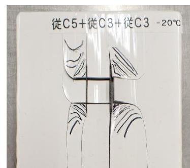
図3 試験片の変状の様子 (試験片番号3, \Delta T=70^\circ\text{C} )
